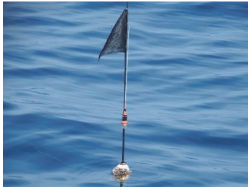
図 5 漁具に設置された AIS
