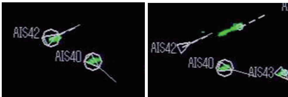
図 2 漁船のレーダ画像と簡易型 AIS 情報が重畳しているが (左図)、漁船が走り出しても AIS のマークが追従しない
