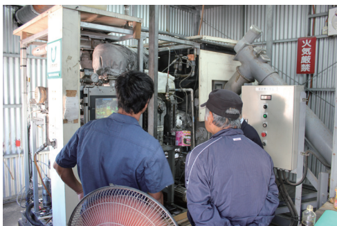
鳩間島に設置された油化装置
