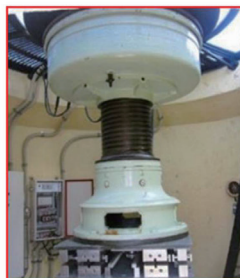
水銀(槽)を使用した回転機構部
