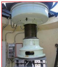
水銀(槽)を使用した回転機構部
